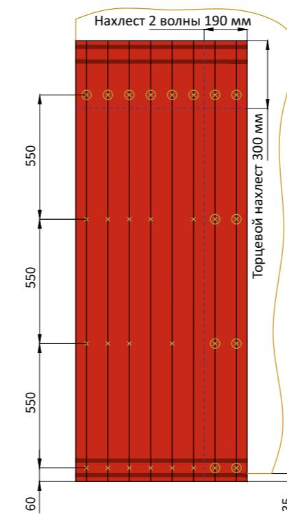
• На данных уклонах, при забивании гвоздей, не следует ориентироваться на разметку, нанесенную на лист! Забивать гвозди следует согласно схеме.
