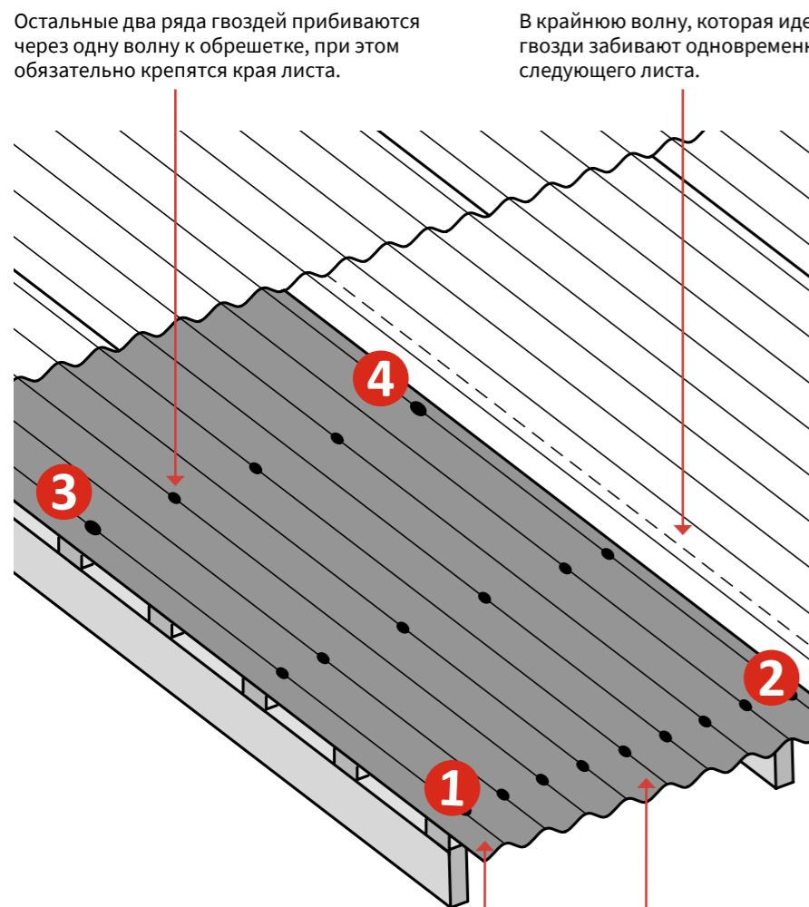
В крайнюю волну, которая идет внахлест, гвозди забивают одновременно с монтажем следующего листа.
